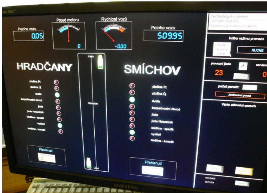
Obrázek 3 Stanoviště strojníka – vizualizace provozních stavů a veličin
